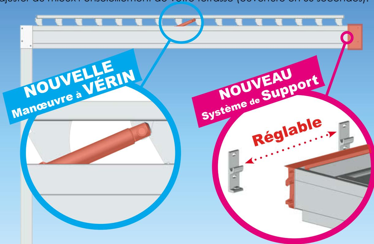
Le vérin nous permet de manœuvrer un tablier pouvant aller jusqu'à 20m<sup>2</sup> (4m x 5m) grâce à sa force de 2400N. Il est totalement intégré dans la poutre latérale afin d'être rendu invisible lorsque les lames sont fermées. Sa fixation est réalisée par deux pièces coulissantes dans la poutre et dans le profil de manœuvre (aucune mécanisation).
