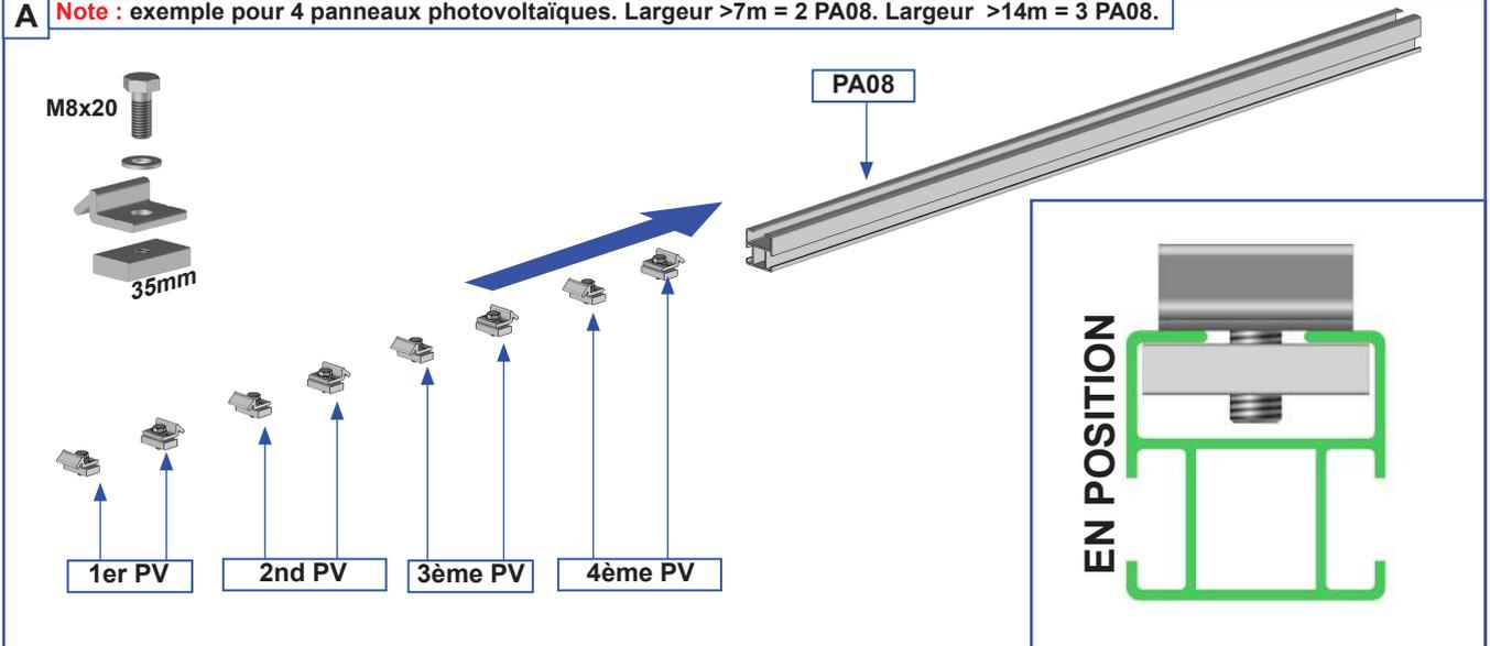
**B** **Note :** exemple pour 4 panneaux photovoltaïques. Largeur >7m = 2 PA08. Largeur >14m = 3 PA08.
