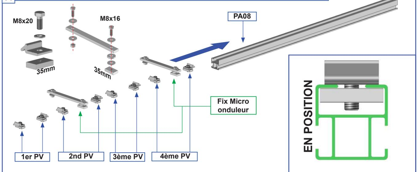
**B** Note : exemple pour 4 panneaux photovoltaïques. Largeur >7m = 2 PA08. Largeur >14m = 3 PA08.
