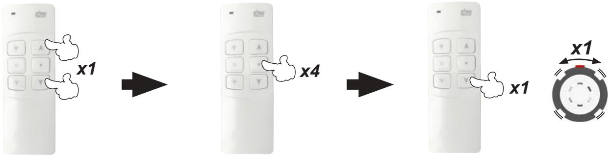
1 - Appuyez 1x sur MONTÉE et DESCENTE simultanément
