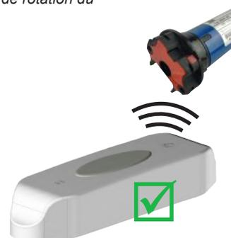
1 - Mise sous tension, le moteur fait une légère rotation
