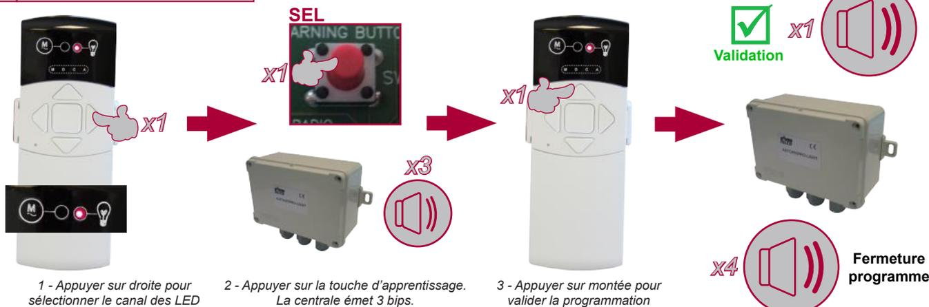
1 - Appuyer sur droite pour sélectionner le canal des LED
