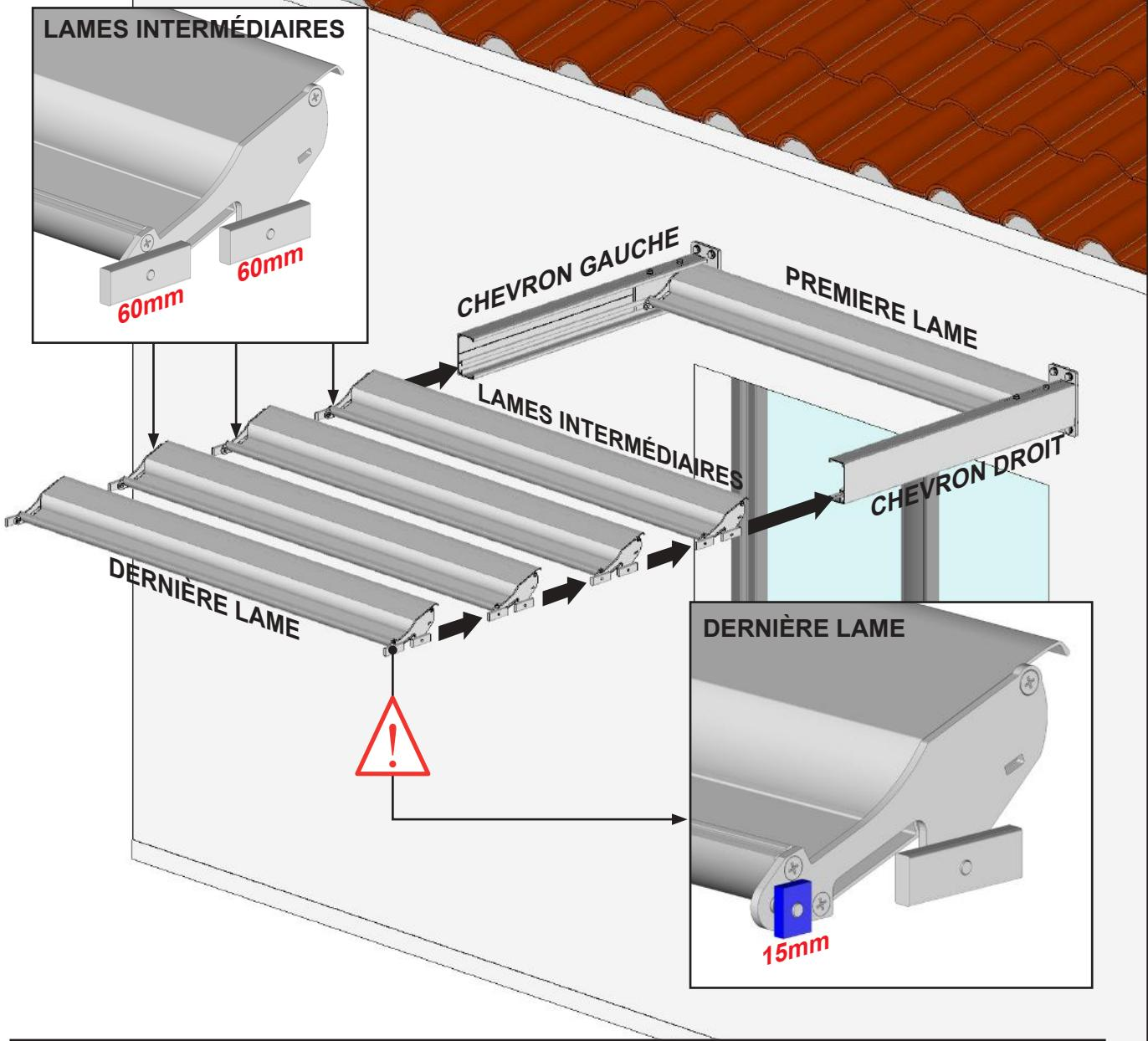
**Positionnez les plaquettes des lames en butée les une contre les autres et les verrouiller une fois en position.**
