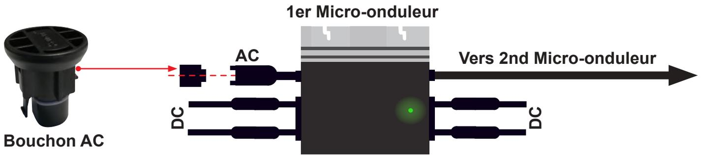
**Attention, les bouchon MC4 sont utilisés sur les kits de panneaux impairs seulement.**
