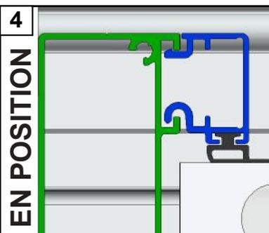
Finir le clippage jusqu'au profil mural. Réaliser les mêmes opérations pour clipper le second profil de recouvrement côté opposé.
