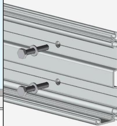
*Adapter la fixation à la nature du mur. Fixation avec des vis  $\varnothing 10\text{mm}$ . Kit de vis et rondelle non fournis. Dans le cas d'installation à l'aide d'un kit de scellement chimique, se référer aux instructions d'utilisation du produit utilisé.*
