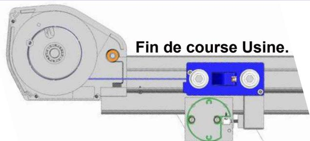
2 - Actionner la vis de fin de course fermeture selon votre configuration afin de positionner la barre de charge coulissante en position finale.
