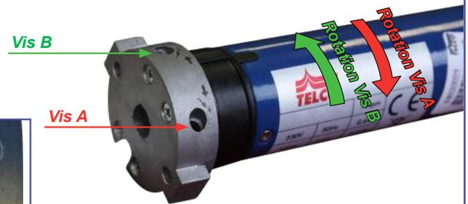
Fin de course : Actionner la vis vers le «+» pour plus de fermeture ou d'ouverture, vers le «-» pour moins de fermeture ou d'ouverture.
