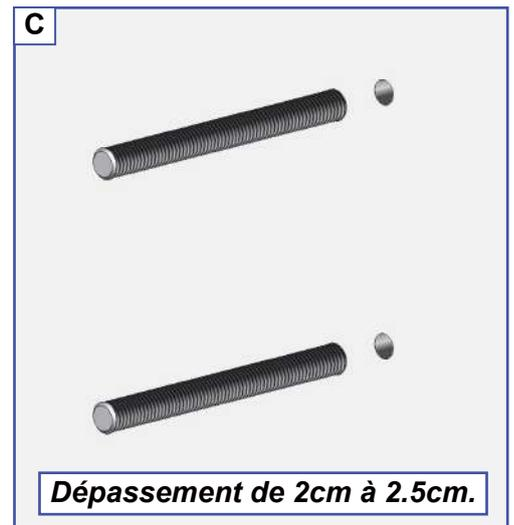
**Adapter la fixation à la nature du mur. Fixation avec des vis Ø10mm. Kit de vis et rondelle non fournis. Dans le cas d'installation à l'aide d'un kit de scellement chimique, se référer aux instructions d'utilisation du produit utilisé.**
