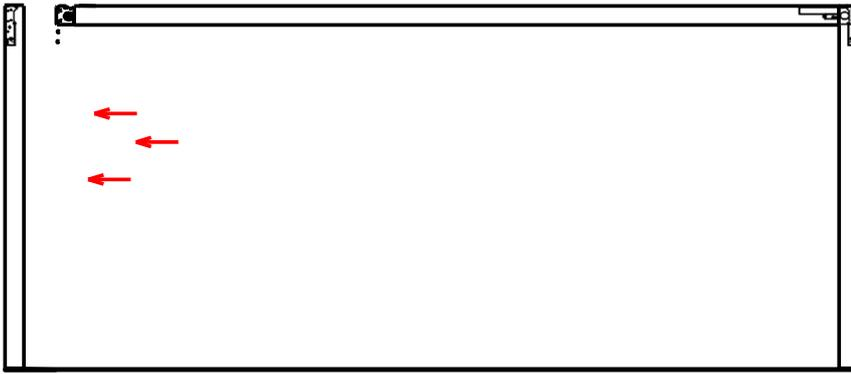
4.2 L'ensemble de la glissière et du profilé de support de devant ainsi créé, doit être déplacé vers le portail arrière.
