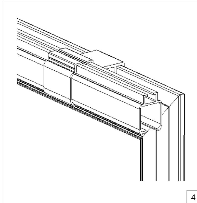
Une fois les supports rail O insérés, disposer l'ensemble sur le profilé cadre.
