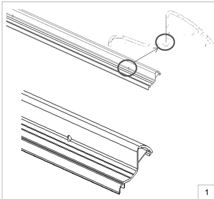
Percer des trous  $\varnothing$  4 ou 5 mm tous les 500 mm dans le seuil pour l'évacuation de l'eau.
