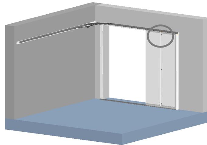
Insertion des chariots de guidage dans le rail
