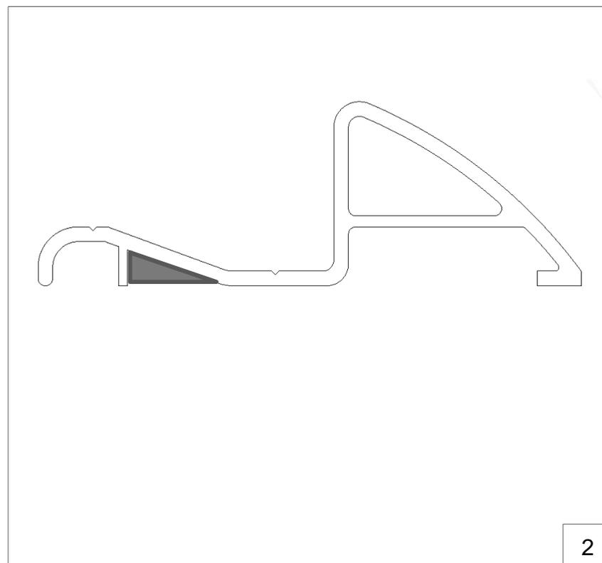
Remplir la forme grise de joint silicone pour assurer l'étanchéité.
