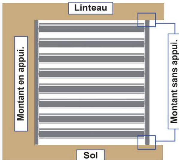
La pose en appui un côté consiste à fixer le brise soleil CLAUSTRA en 3 points. Fixation du montant en appui sur le mur et fixation des deux platines de fixation au sol et sous linteau.
