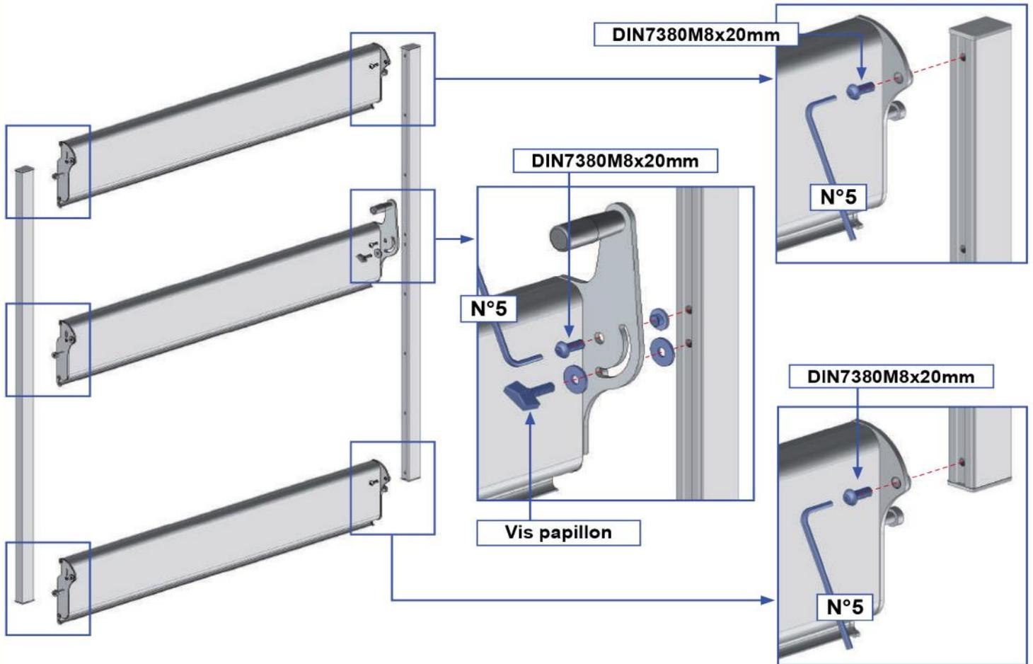
6 Ouvrir les lames à 45° et verrouiller la position à l'aide de la vis papillon.
