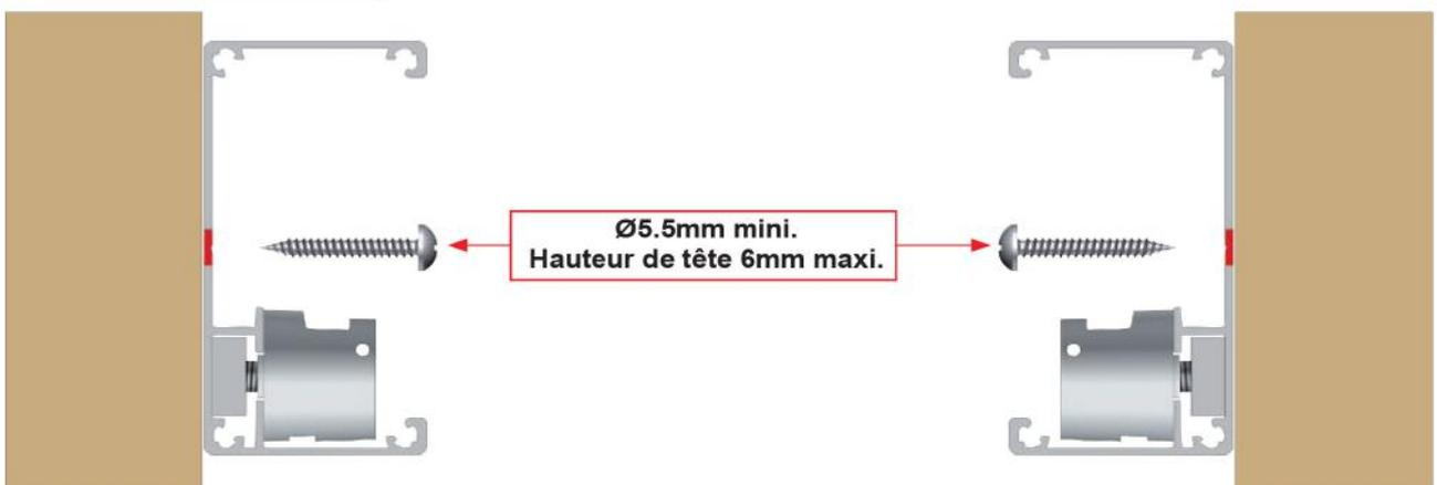
Adapter la fixation à la nature du mur. Kit de vis et rondelle non fournis. Dans le cas d'installation à l'aide d'un kit de scellement chimique, se référer aux instructions d'utilisation du produit utilisé.
