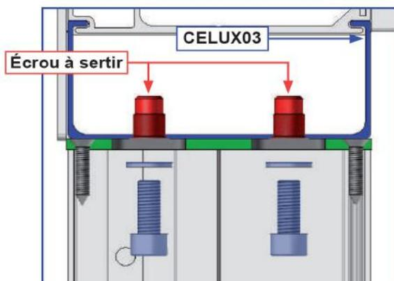
Répéter les opérations du paragraphe 2 page 3. Mais réaliser la fixation du montant sur le PBSO45 à l'aide d'un kit de vis Ø8mm non fourni.
