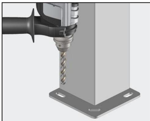
Fixer les platines au niveau de chaque plot béton réalisé auparavant par deux vis minimum.
