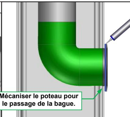
**Note :** l'évacuation sur poteau peut être orientée selon votre choix. Choisissez la face du poteau à mécaniser afin d'obtenir l'orientation de l'évacuation désirée.
