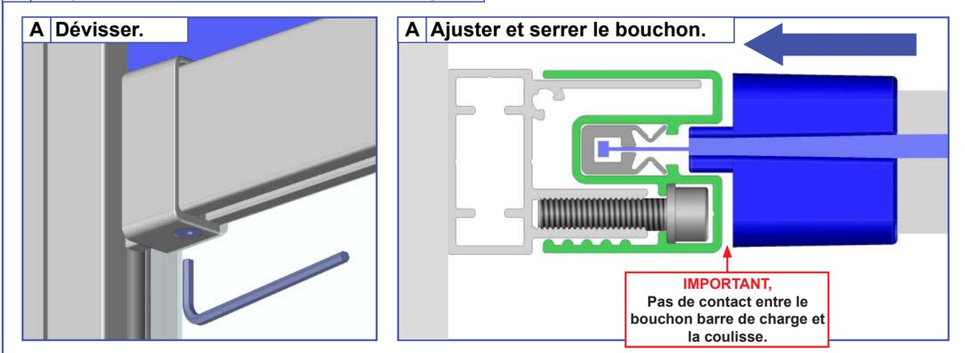
**21 Réaliser les fin de course d'ouverture et de fermeture. Se référer à la motorisation choisi.**
