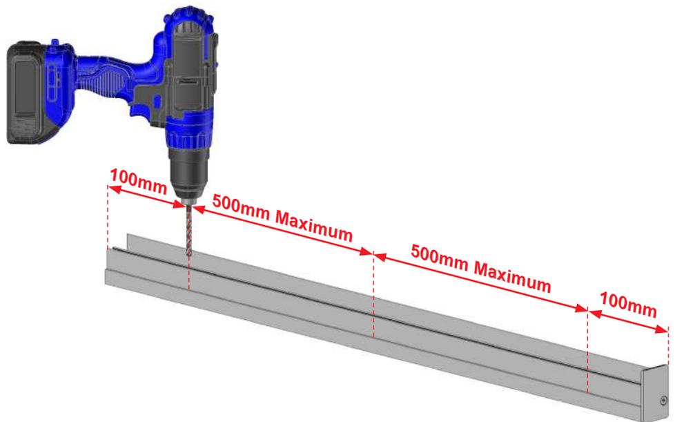
Fixation avec des vis Ø4.2mm.
