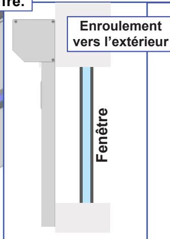
Guider le ZIP et le bouchon de barre de charge dans la coulisse
