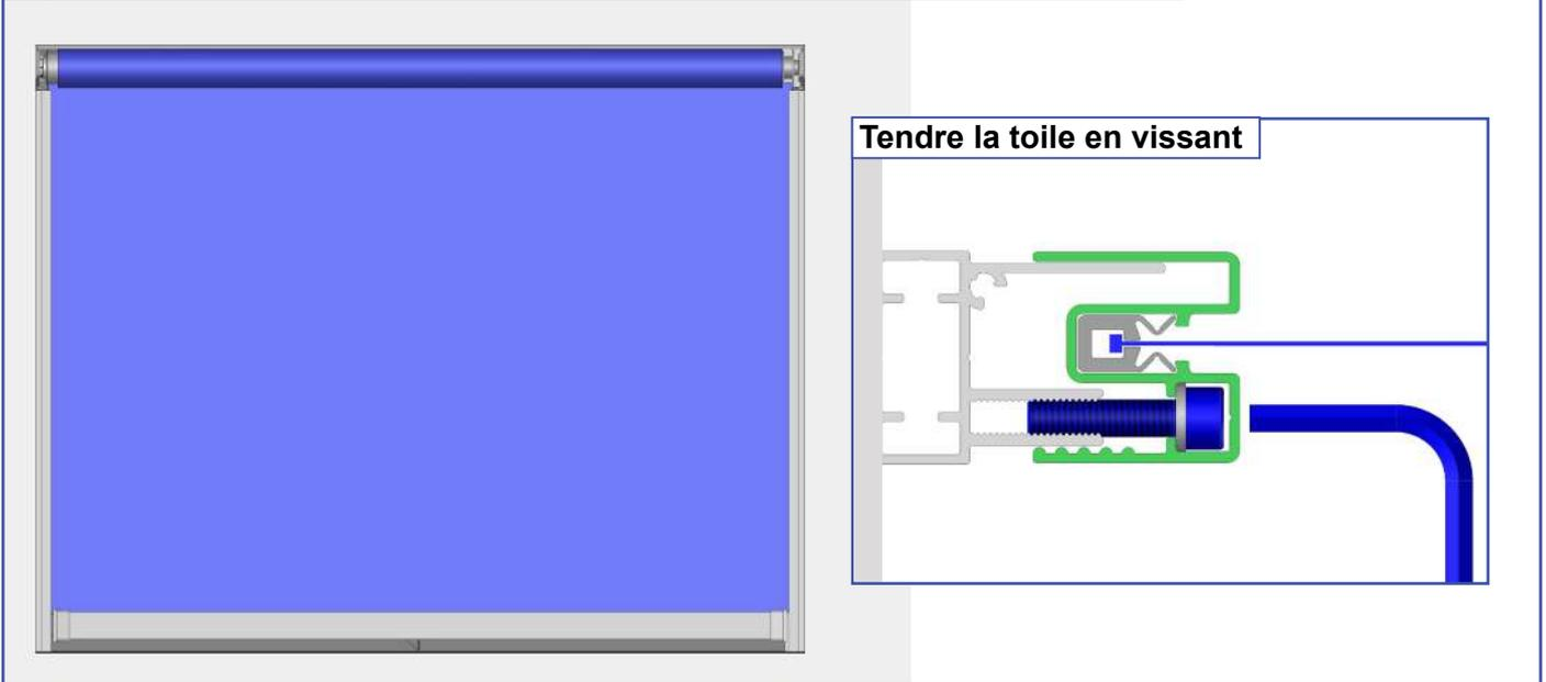
13 Réajuster les bouchons de barre de charge.
