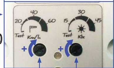
**Réglage capteur vent**
