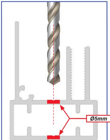
Fixation avec des vis Ø4.2mm.
