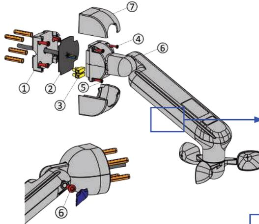
A l'aide d'un tournevis plat, régler les potentiomètres vent et soleil. Attention régler le potentiomètre vent en fonction de la classe technique de votre store.
