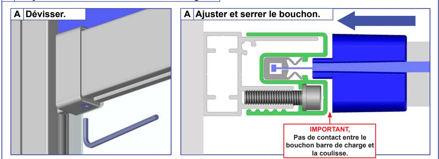
17 Réaliser les fin de course d'ouverture et de fermeture. Se référer à la motorisation choisi.
