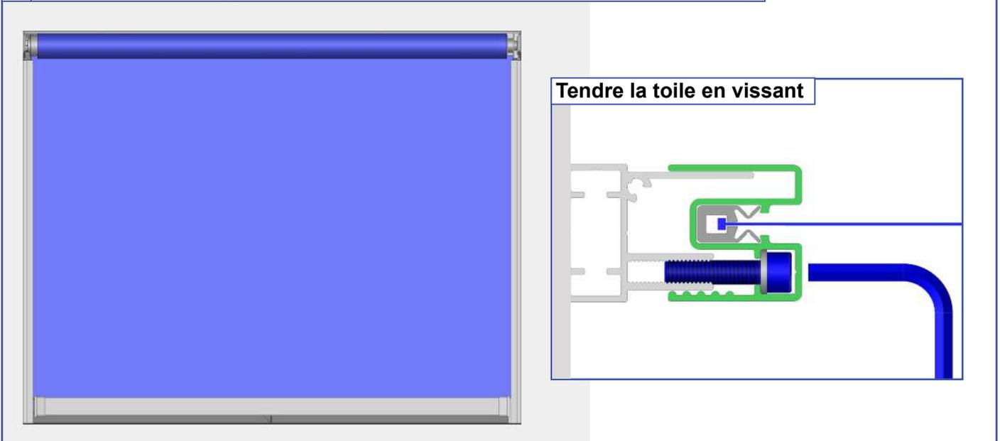
**12 Réajuster les bouchons de barre de charge.**
