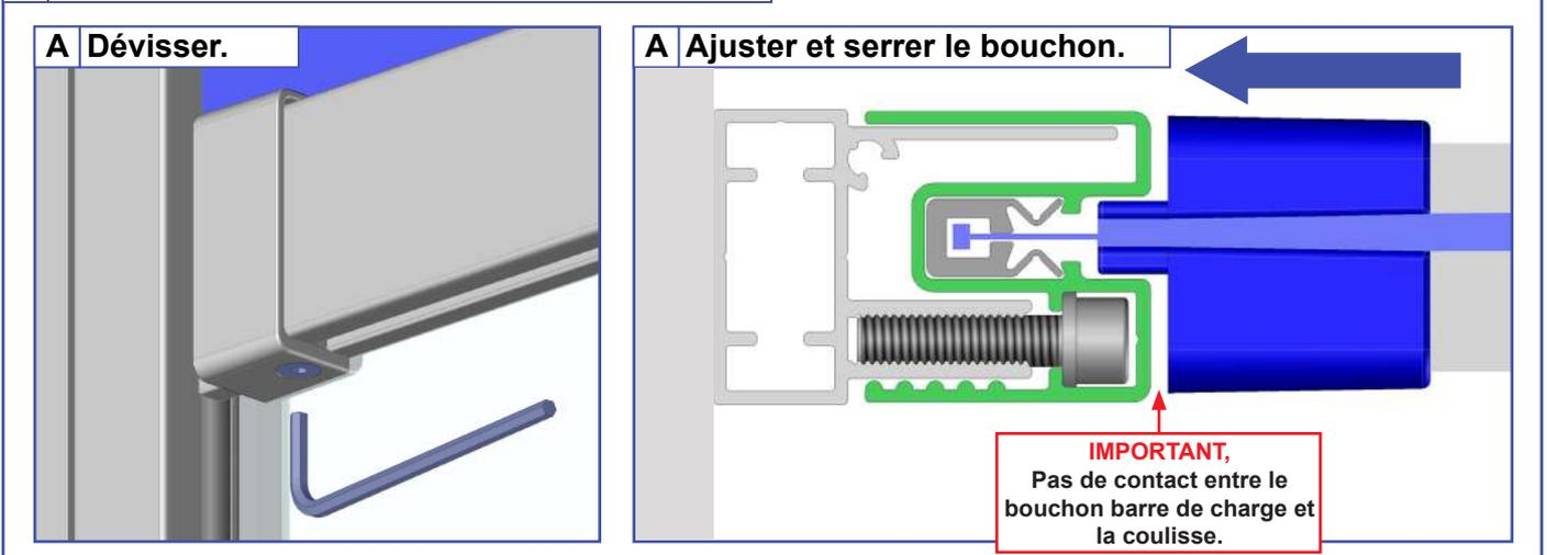
**13 Réaliser les fin de course d'ouverture et de fermeture.**
