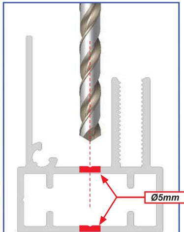
Fixation avec des vis Ø4.2mm.
