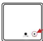
Appuyer sur la touche **PROG** de l'émetteur à effacer à l'aide d'un trombone
