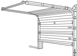
Le poids maximal est donné pour une porte qui s'ouvre et se ferme librement sans frottements importants. Le fonctionnement manuel de la porte doit être possible avec une force inférieure à 15kg (150N). Sinon, il faut réduire le poids maximal donné précédemment.
