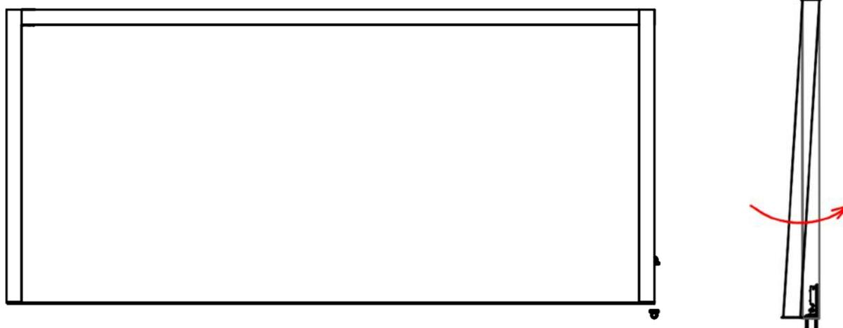
9.1. Déplacez la structure par le bas autant que possible, afin de visser les éléments de fixations des pieds au sol avec des vis appropriés.
