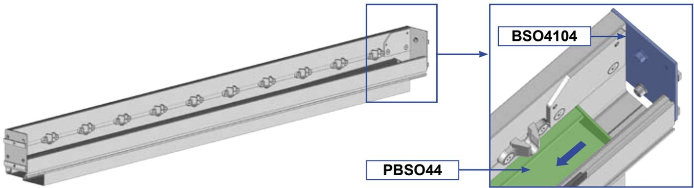
Décaler la gouttière intérieure PBSO44 vers l'avant, et glisser la rallonge de raccordement de LED fournie avec le kit LED. La rallonge passe sous le bouchon BSO4104 et se loge dans la gouttière PBSO44.
